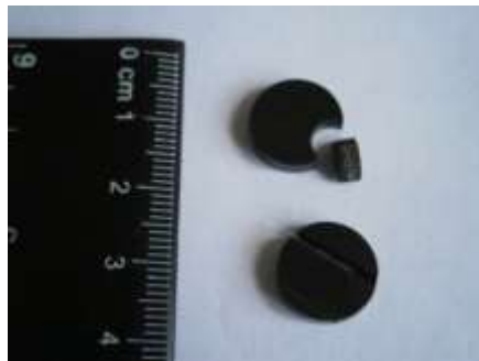
Рис.5 – Виконане контурне різання пластинки пропонованим гібридним способом (та для порівняння спроби виконати різання традиційними технологіями – на фото знизу)
