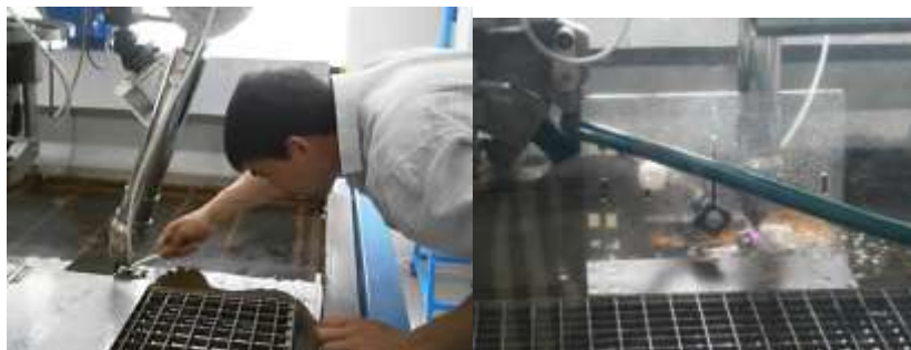
Рис. 2 – Юстировка предметного столику перед дослідом
