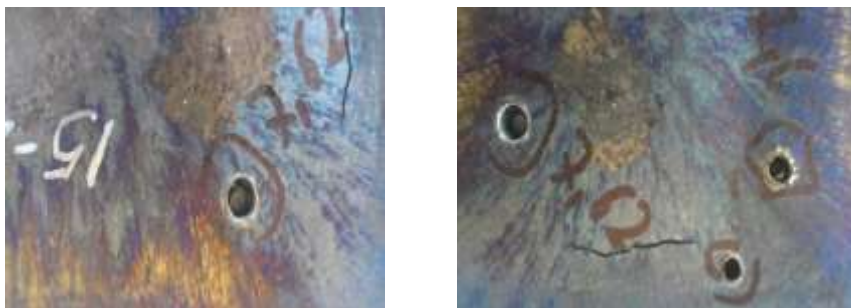
Рис. 1 – Композиции титан-алюминий-титан, полученные сваркой взрывом, после прострела пулями калибра 7.62 и 5.56
