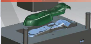
Siemens NX Tooling: Дизайн пуансона штампу
